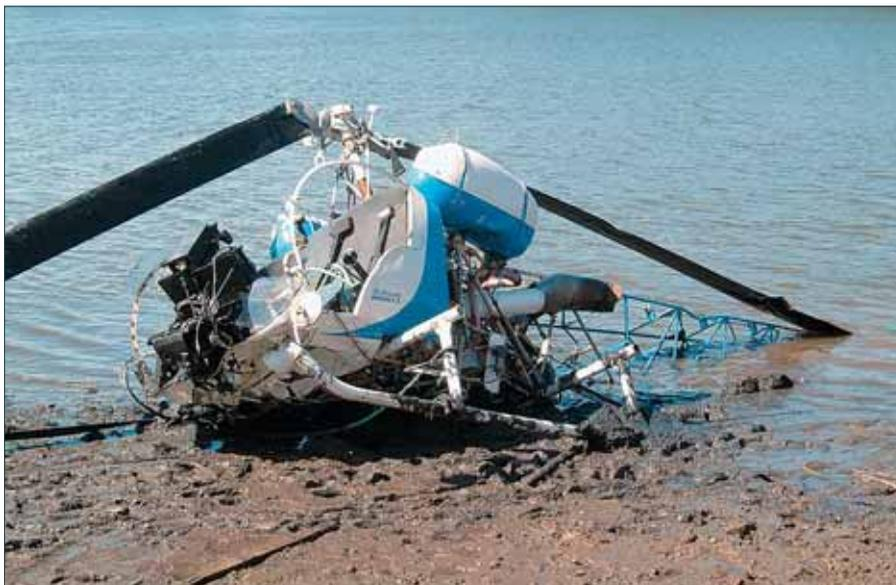
Планер вертолета под действием первичного управляющего воздействия начинает вращательное движение на пикирование. Поднимающийся относительно несущего винта рулевой винт создает увеличивающийся кренящий момент вправо (для вертолетов с направлением вращения винта против часовой стрелки при виде сверху). Вертолет заваливается вправо.
