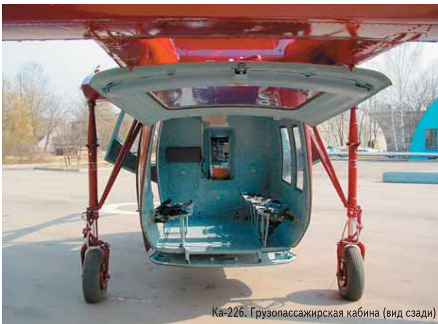
Ка-226. Грузопассажирская кабина и вертолет-носитель
