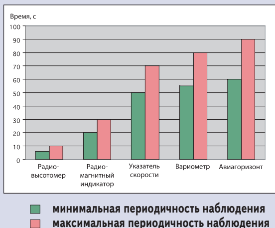
Рис. 3. Продолжительность перерывов в обращении летчиков к показаниям приборов в полетах на вертолетах вблизи земли
