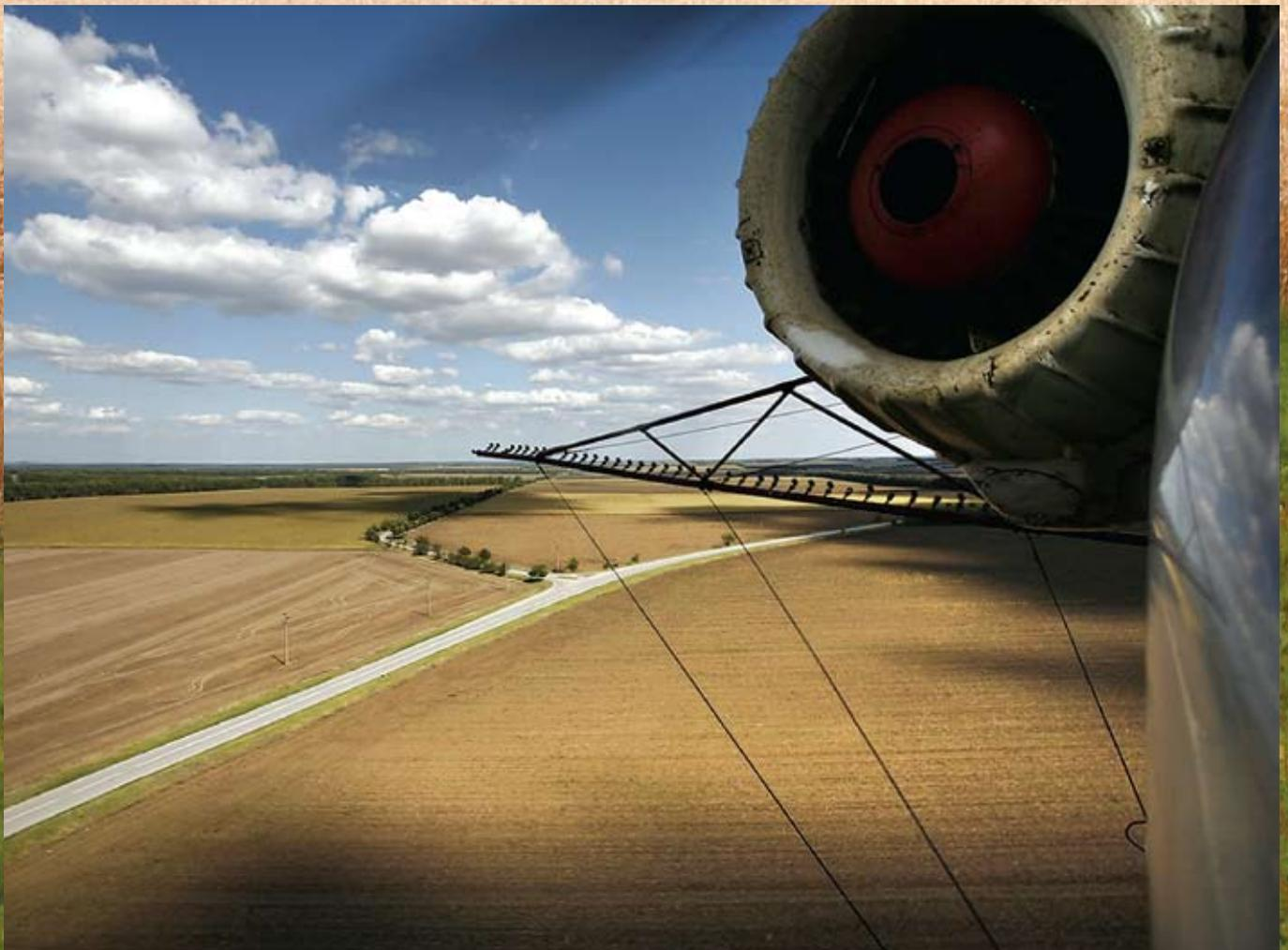
из преимуществ вертолета заключается в том, что он может летать на малых скоростях (40–60 км/ч). Это особенно важно для химобработки сорной растительности, которая проводится по периметру поля. В этом случае вертолет зависает над пораженными участками, обеспечивая высокую точность внесения пестицидов. Самолету висеть не дано, поэтому орехов в работе не избежать.
