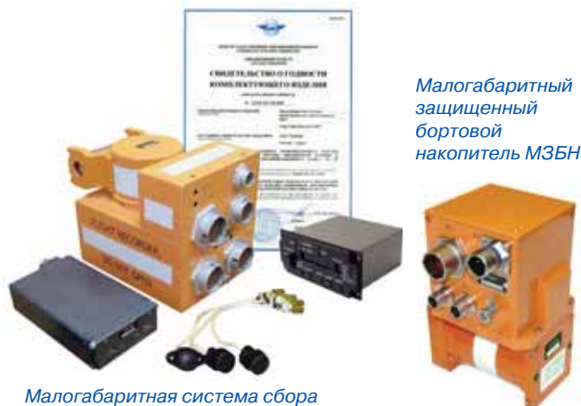
Малогабаритная система сбора и регистрации полетной информации МБР-ГА-02
