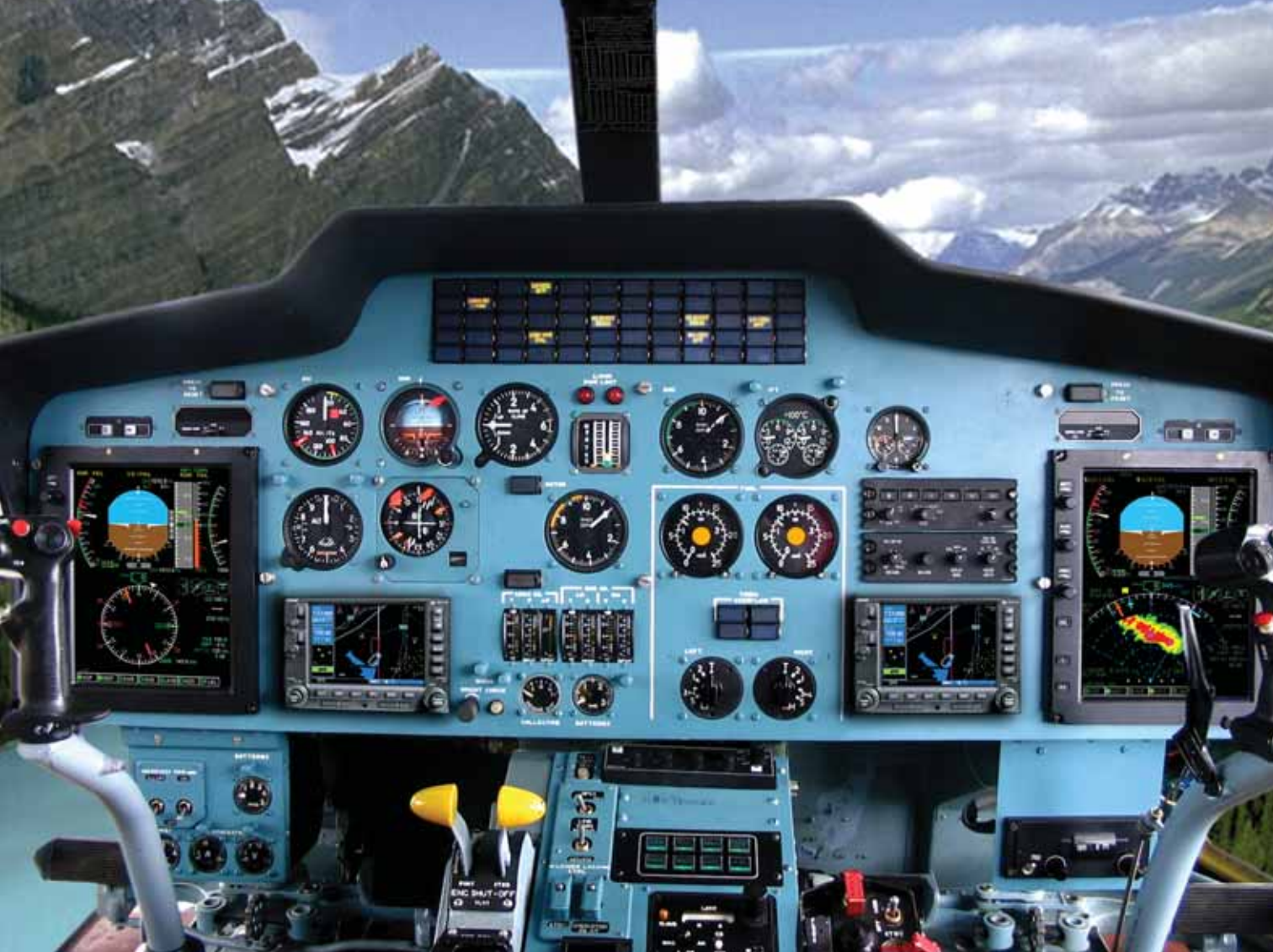
Приборная панель вертолета Ка-32А11ВС с оборудованием ОАО «УКБП»
