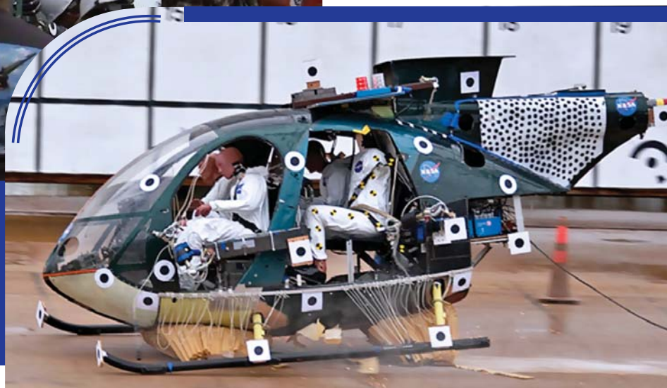
В кабину легкого вертолета посадили четыре манекена и сбросили с высоты чуть более 10 м. Ущерб был минимальным
