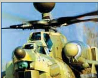
В июле 2007 года прошли испытания Ми-28НЭ в условиях жаркого и сухого климата с высоким уровнем запыленности воздуха. В ходе полетов испытаниям подвергались сам вертолет, его вооружение, а также комплекс бортового радиоэлектронного оборудования, в том числе прицельно-пилотажные системы круглосуточного применения. В жес-
