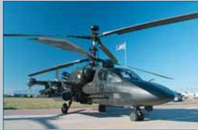
Двухместный боевой вертолет Ка-52 был создан в кратчайшие сроки в 1996 году на базе одноместного Ка-50 благодаря высокой унификации конструкций (свыше 80%) двух машин. Конструктивные отличия в основном касаются носовой части вертолетов – Ка-52 обрел двухместную кабину. Основные отличия касаются БРЭО и по заявлению разработчика вызваны новой концепцией применения боевых вертолетов на поле боя. Ка-52 помимо функции ударного вертолета придана функция «командирского» вертолета с возможностью
