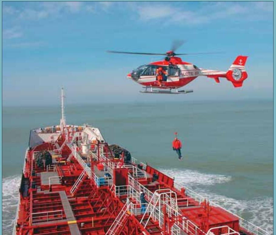
Рулевой винт EC135 – фенестрон нового поколения диаметром 1 м с жесткозакрепленными спрямляющими лопатками в кольцевом канале и 10 лопастями, установленными асимметрично в плоскости вращения и с углом стреловидности по передней кромке. Окружная скорость концов лопастей 185 м/с. Такая конструкция фенестрона позволяет снизить потребляемую мощность и повысить аэродинамическое качество, а также снизить внешний уровень шума. Он на 7 дБ ниже предела, установленного правилами ICAO.
