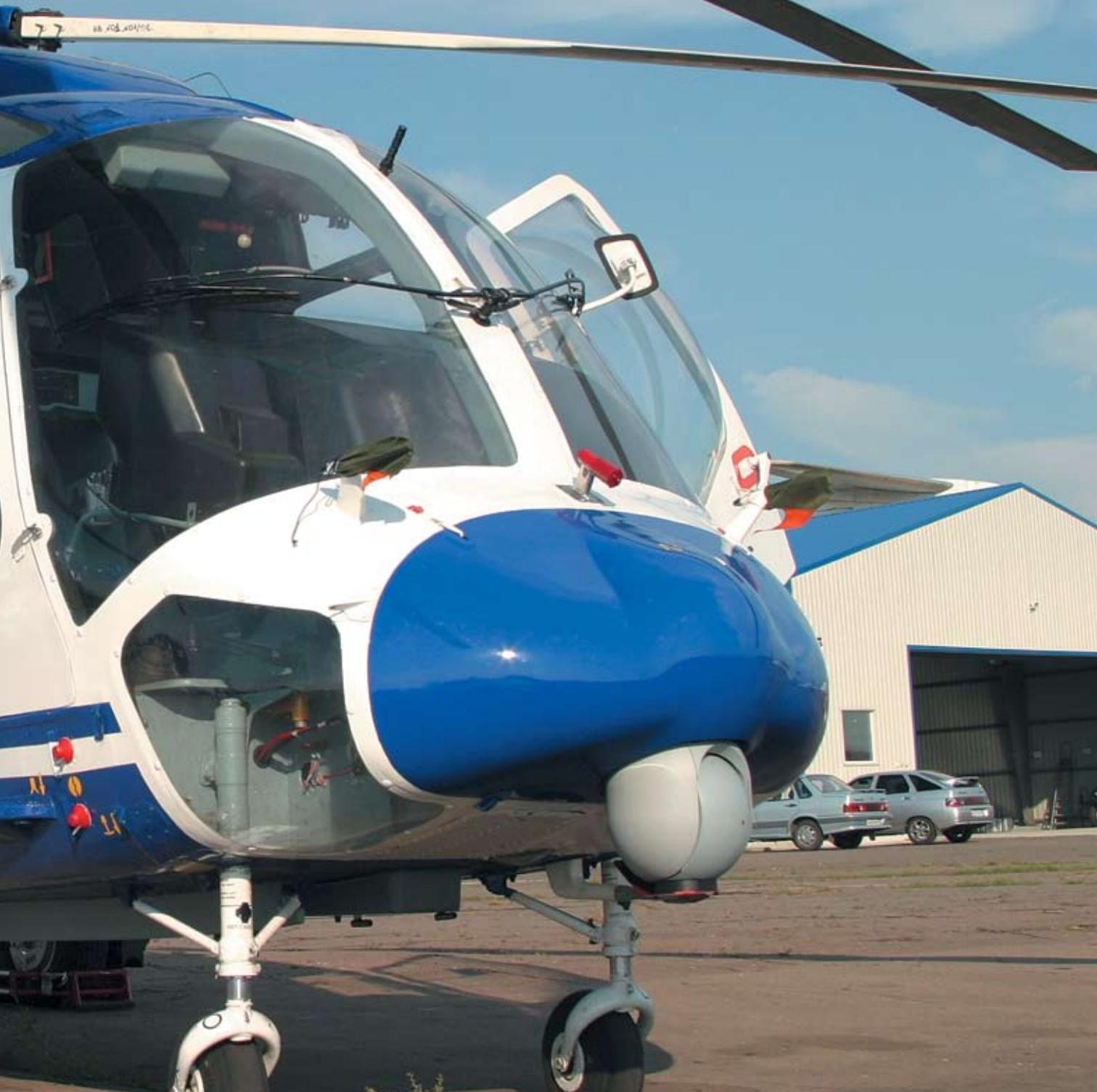
На нашем вертолете установлено специальное оборудование. О нем стоит рассказать отдельно. При беглом взгляде на вертолет в глаза бросаются три необычных устройства: специальная видеокамера под головным обтекателем машины, короткая, похожая на милицейский жезл полосатая антенна и массивный репродуктор, закрепленные
