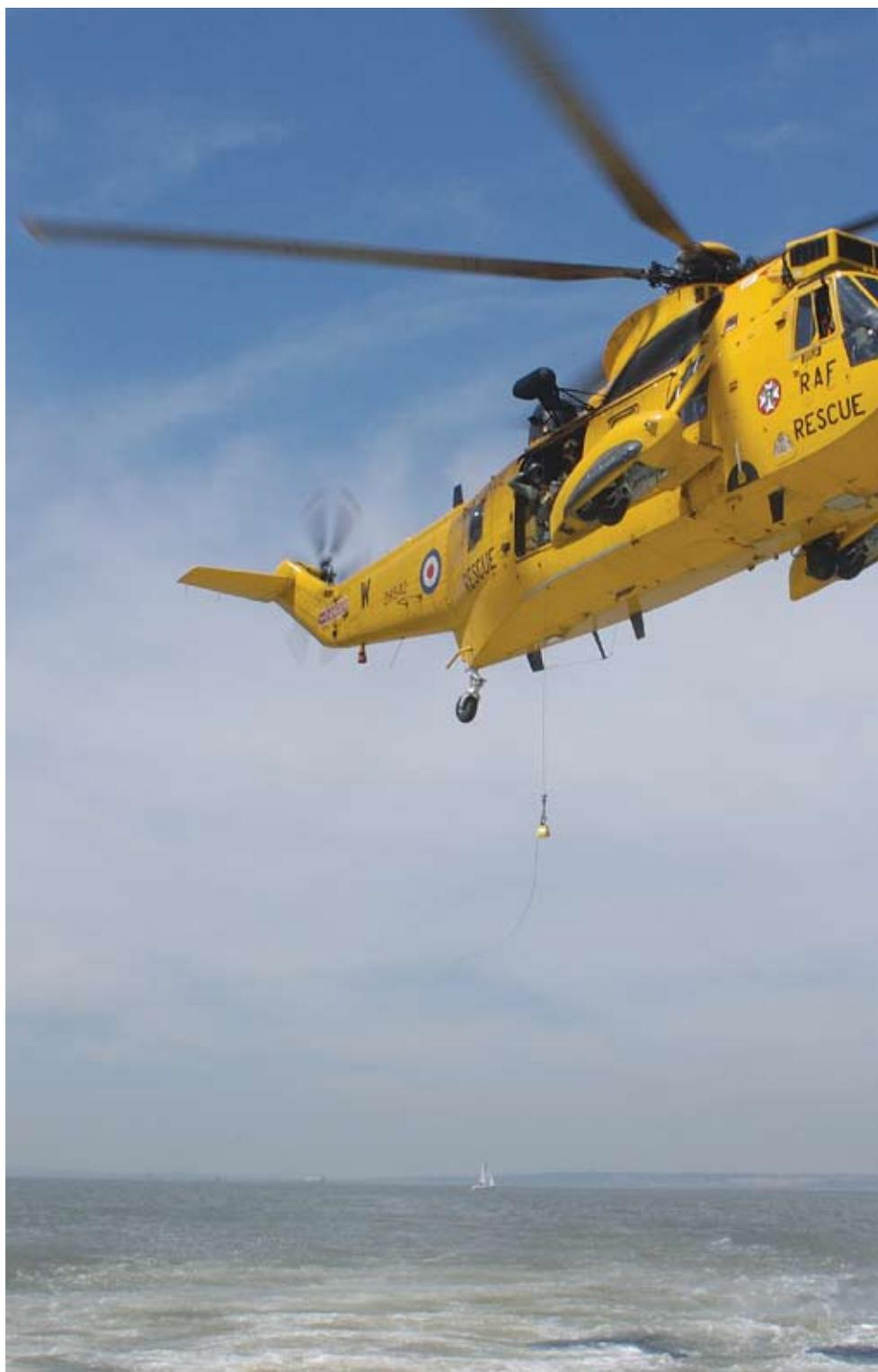
с помощью гидроакустической станции, в составе его БРЭО имеется автоматическая система стабилизации на режиме висения и радиовысотомер. Благодаря большой грузоподъемности вертолет способен нести и средства поражения подводных лодок – акустические самонаводящиеся торпеды и глубинные бомбы. Нижняя часть его фюзеляжа была сделана водонепроницаемой, разделенной на герметичные отсеки. Этой части фюзеляжа
