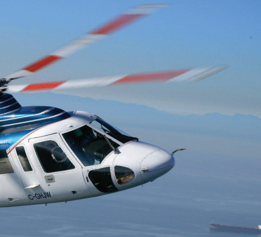
усовершенствования позволили S-76C+, сертифицированному для полетов по приборам с одним пилотом, работать в плохих погодных условиях днем и ночью. Подогреваемые стекла кабины и двойные стеклоочистители даже в непогоду обеспечивали пилоту S-76C+ хорошую видимость. На вертолете были установлены два двигателя Turbomeca Arriel 2S1, благодаря которым его крейсерская скорость составила 286 км/ч, а практическая дальность – более 640 км.
