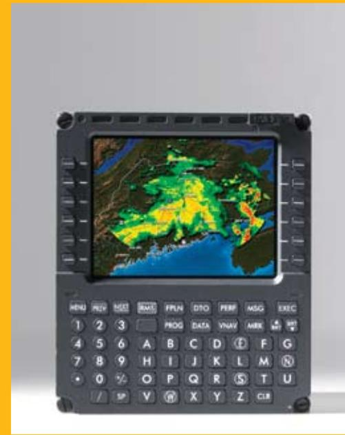
мости аппаратных средств и программного обеспечения используется больше функций в авиационном наборе, исключая переделку пульта управления. В TopDeck реализована концепция виртуальных пультов. Интуитивное движение курсором, очень похожим на компьютерную мышь, дает возможность пилоту получать доступ к любой функции, а также осуществлять контроль любой системы – летчик должен лишь выбирать демонстрируемые системой варианты.
