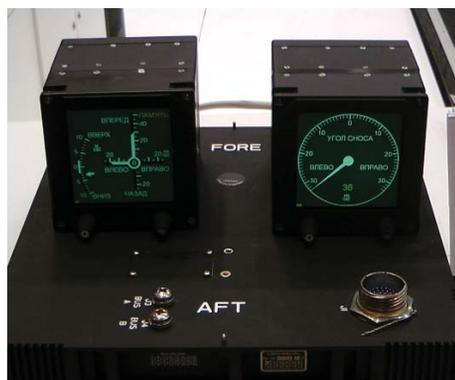
Комплект оборудования для измерения и отображения составляющих вектора путевой скорости и угла сноса
