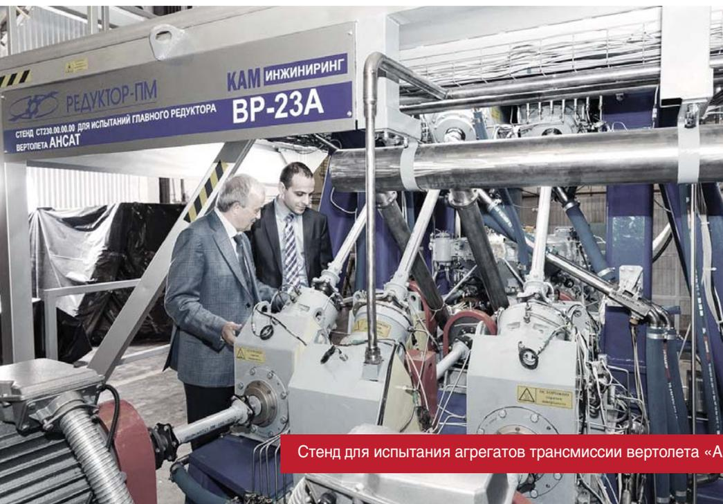
Стенд для испытания агрегатов трансмиссии вертолета «Ансат»
