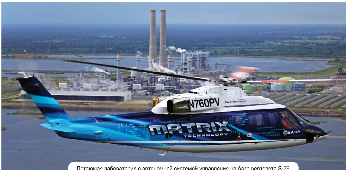
Летающая лаборатория с автономной системой управления на базе вертолета S-76
