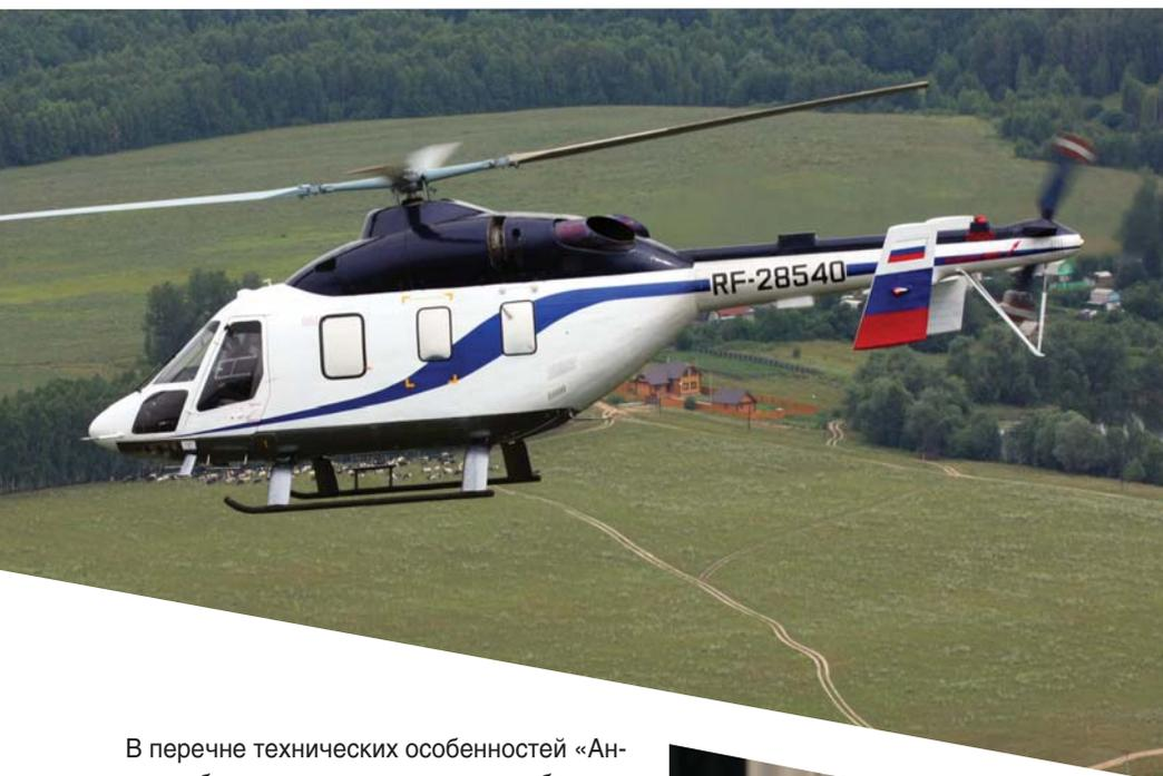
В перечне технических особенностей «Ансата» бесшарнирная втулка, не требующая обслуживания. Проводится работа по переводу ее эксплуатации по техсостоянию. Лопасти несущего винта композитные. Идеология конструктива лопасти соответствует Ка-26. Бесшарнирная система подвески лопастей не только увеличила управляемость и маневренность вертолета, уменьшила стоимость и массу конструкции, но и значительно снизила эксплуатационные расходы. Замена ча-
