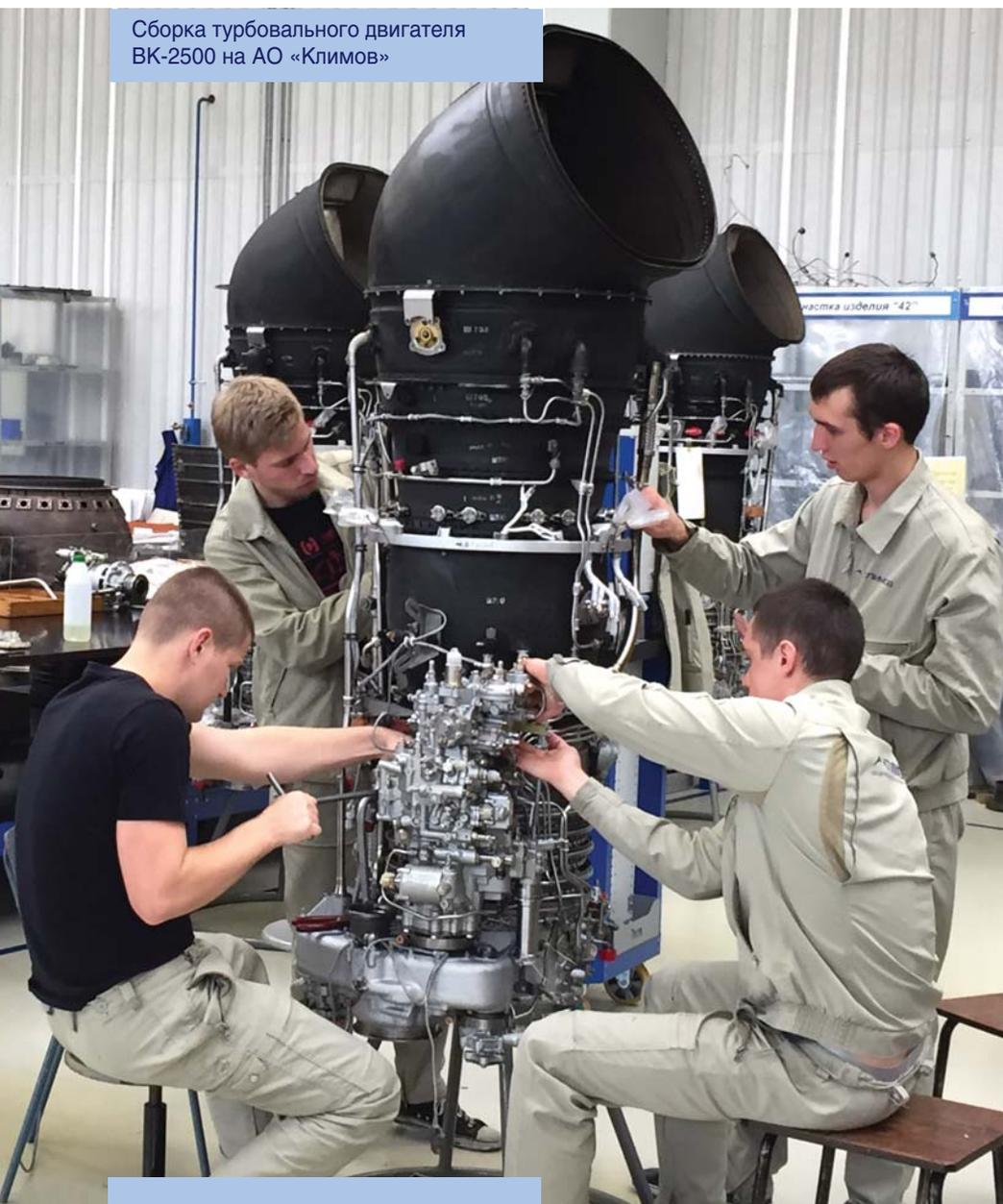
**ВК-2500, созданный на замену вертолетному двигателю ТВЗ-117, в значительной степени вобрал в себя новации самолетного моторостроения**
