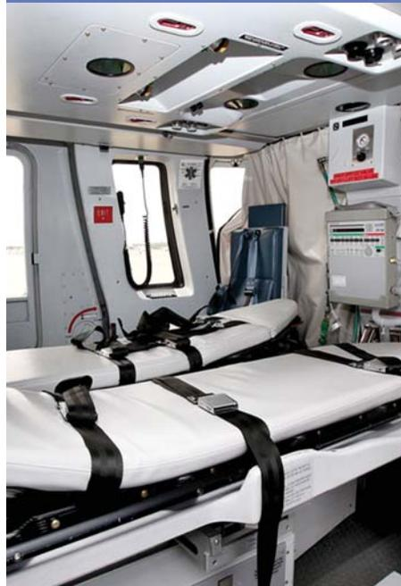
Продукт третьего поколения предоставляет увеличенные функциональные возможности и долговечность, в том числе, снижение массы на 16% по сравнению с предыдущими композитными AeroSled (экономия веса девять фунтов). Конструкция из алюминия машинной обработки предназначена как для эвакуации, так и для переноски пациентов. Она же обладает повышенной износоустойчивостью и прочностью.
