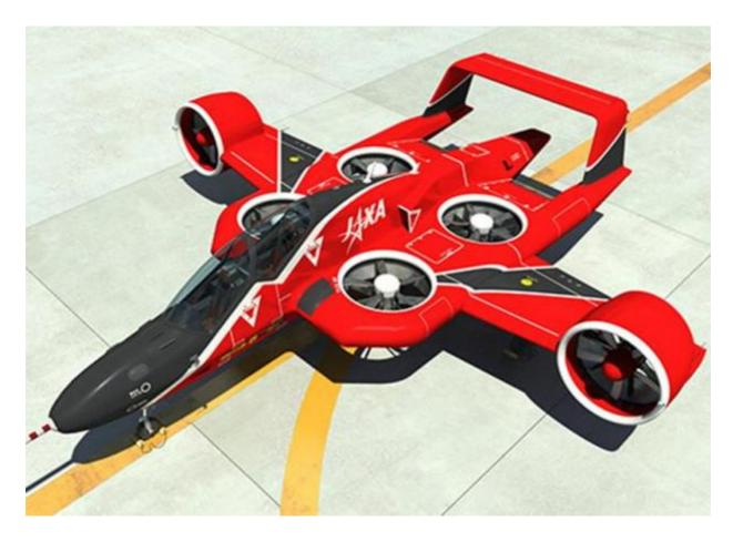
Проект предусматривает размещение двухместной кабины в передней части фюзеляжа для пилота и пассажира или для двух пассажиров - конструкторы пока не определились, будет ли аэротакси опционально пилотируемым или полностью беспилотным. Пилот и пассажир будут размещаться тандемно, то есть друг за другом. Другие подробности о перспективном летательном аппарате пока неизвестны. Также пока не определены сроки начала летных испытаний полноразмерного демонстратора технологий.
