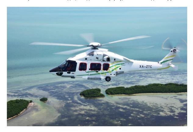
Еще одним фактором конкурентоспособности вертолета является гарантированная крейсерская скорость в 150 узлов и максимальная крейсерская скорость в 160 узлов; висение вне зоны влияния земли с максимальной взлетной массой в 7,5 тонн возможно на высоте 1767,84 метров (5800 футов) в условиях температуры +20°С по Международной стандартной атмосфере; а также впечатляющий запас мощности и взлет-посадка на вертолетную площадку при условии +20°С по Международной стандартной атмосфере.
