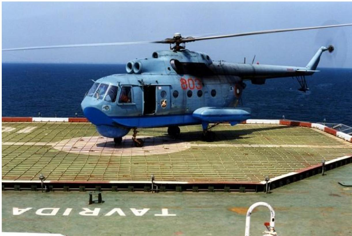
Ми-14 разрабатывался в качестве специализированного противолодочного вертолета для Военно-морского флота СССР, однако с 1979 года в модельном ряду появились буксировщик минных тралов Ми-14БТ и многоцелевая поисково-спасательная версия Ми-14ПС.
