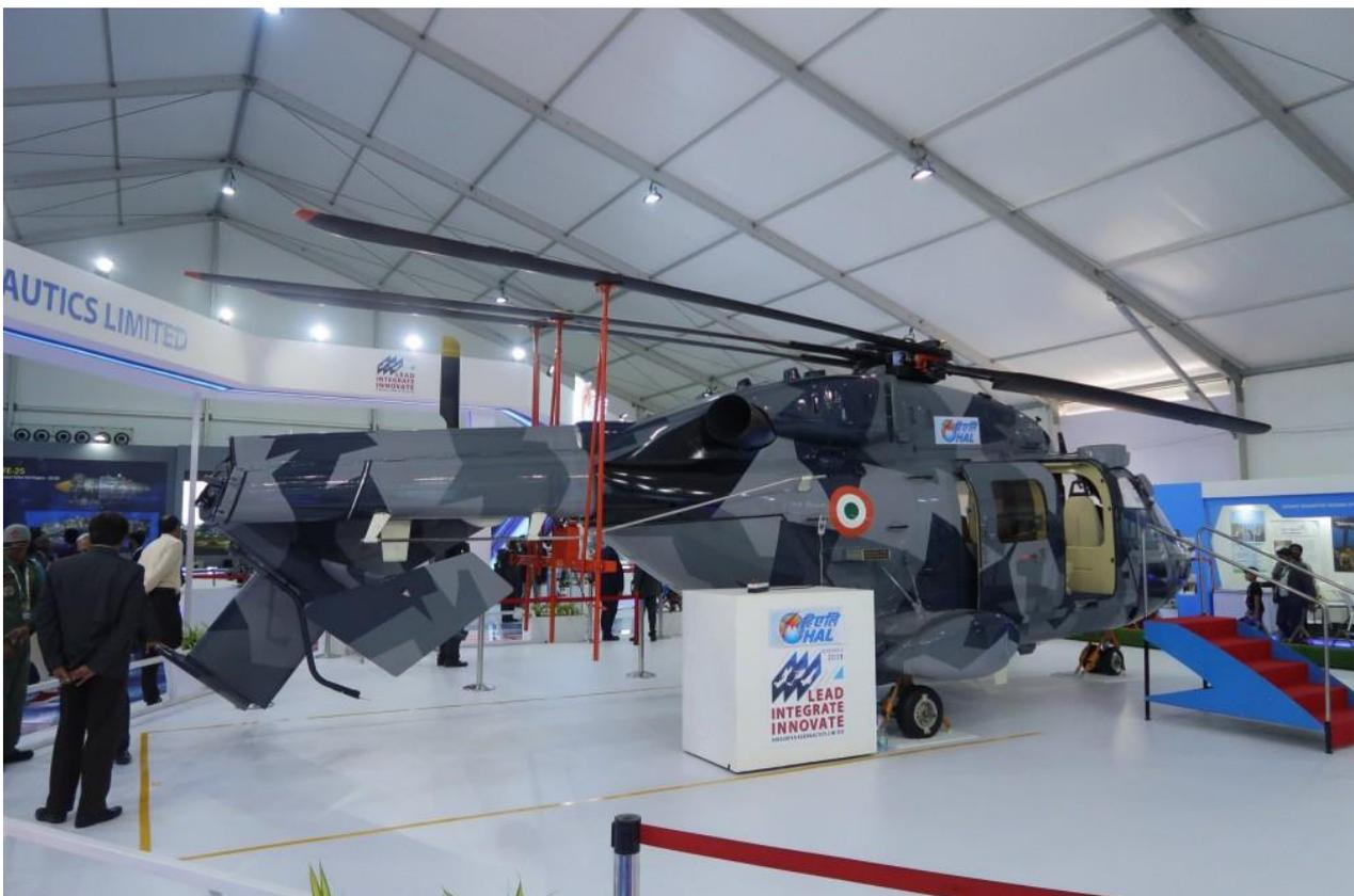
Вертолет NUH создается в интересах ВМС и береговой охраны Индии при участии проектного управления ВМС Индии, и должен использоваться в качестве многоцелевого и поисково-спасательного. Первый полет представленного прототипа-демонстратора намечен на 2019 год.
