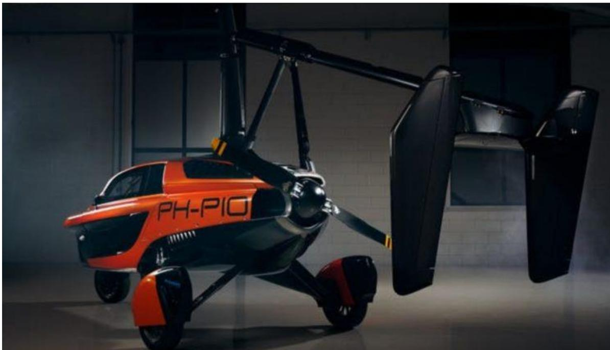
Летающий автомобиль PAL-V Liberty Pioneer Edition был представлен в Женевском международном автосалоне. Аппарат имеет форму гироплана и оснащен огромным винтом, который поднимает всю конструкцию вверх. Благодаря своей форме, он обеспечивает безопасную посадку даже в случае серьезного сбоя. Если по каким-то причинам полет будет невозможен, он сможет ехать по дорогам как обычный автомобиль — благо, его винт аккуратно складывается.
