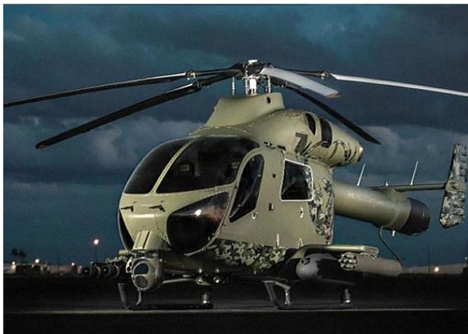
В целом, разработчики полагают, что их вертолет сможет выполнять полеты на скорости 205 узлов, а возможно и больше. Предполагается, что максимальная взлетная масса новой машины составит 3,1 тонны. Крейсерская скорость скоростного разведывательного вертолета составит 160 узлов, а дальность полета — 367 морских миль (680 километров). На консолях крыла MD969 планируется разместить по шесть точек подвески для различного вооружения.
