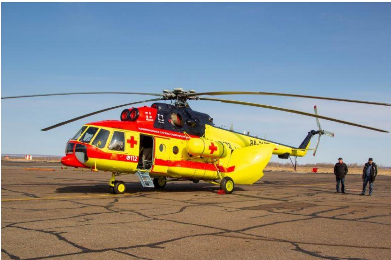
За один рейс вертолет может доставить пять взрослых больных и одного ребенка. Два места для пациентов постоянные, еще трое носилок можно добавить, убрав один из топливных резервуаров из салона. Он вмещает 900 литров горючего и позволяет продлить полет на один час 10 минут. Но при необходимости его можно заменить на места для пациентов.
