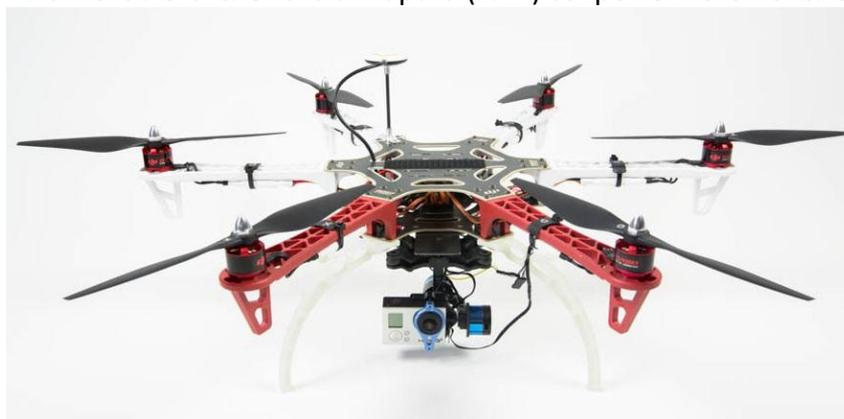
Для пилотирования будет доступен многоцелевой беспилотный летательный аппарат – гексакоптер DJI F550, который может оснащаться камерой, транслирующей видеосигнал на специальный шлем оператора, что позволяет управлять аппаратом от «первого лица».
