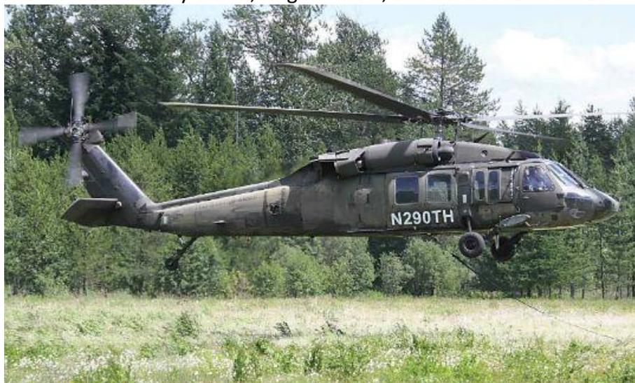
Чтобы успешно применять бывшие военные вертолеты, перед продажей с них демонтируется вооружение и радиоэлектронное оборудование согласно стандартам ITAR (International Traffic in Arms Regulations), нужно получить одобрение Федерального управления гражданской авиации США (военные модели его не получали), перерегистрировать (добавляется ещё одна табличка с
