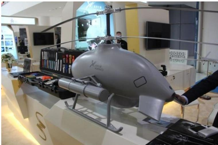
Sky Saker H300 в переводе на русский означает «сокол-балобан» — это первый дрон, созданный по программе производства боевых беспилотников. Вертолёт оснащён оптическими и инфракрасными камерами, а также лазерным целеуказателем. На пилонах размещены две пусковые установки для ракет. Беспилотник может не только самостоятельно поражать цели, но и корректировать огонь союзной артиллерии, давая команды управляемым боеприпасам.
