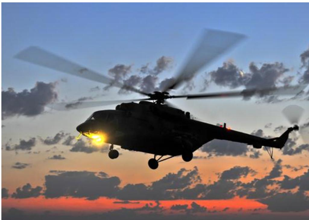
На Ми-8МТВ-5 можно оперативно перебрасывать войсковые подразделения в район проведения боевых действий в любое время суток. Боевой вариант вертолёта оборудуется специальными балочными держателями, на которых размещается вооружение - бомбы общей массой до 2 тонн, до четырёх блоков НАР С-8 или съёмных пушечных установок (23 мм). Есть возможность оснащения управляемыми ракетами.
