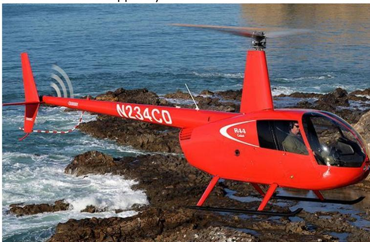
Вертолет представляет собой вариант популярной четырехместной винтокрылой машины R44, предназначенный для авиационных работ и обучения. У него такие же корпус, роторная система и силовая установка (Lycoming O-540-F1B5), как на модели R44 Raven I. Отличие новой версии заключается в том, что R44 Cadet имеет на два кресла меньше; освободившееся место отведено под увеличенный грузовой отсек.
