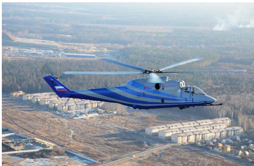
Демонстратор скоростного вертолета совершил первый полет 29 декабря 2015 г. Он создан на базе ударного вертолета Ми-24, который, по словам Шибитова, по аэродинамике близок к параметрам ПСВ. Перед отправкой на испытания фюзеляж был доработан с тем, чтобы снизить сопротивление воздуха.
