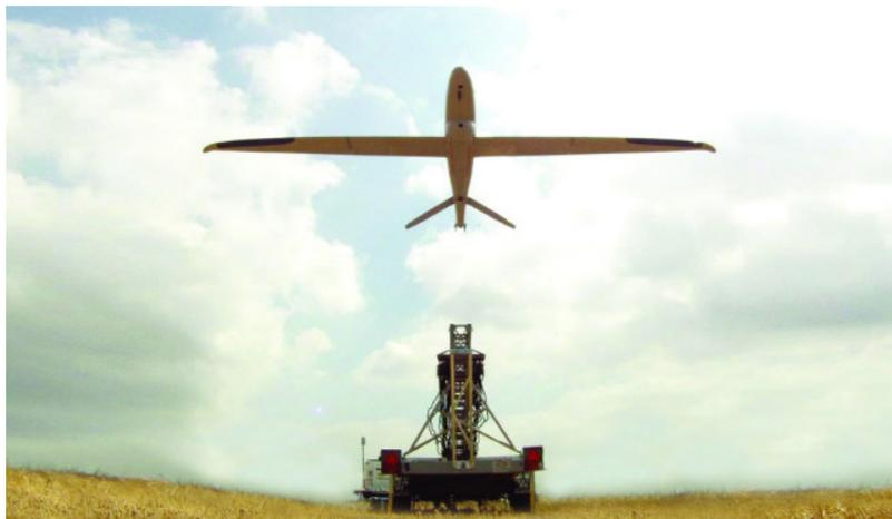
Согласно заявлению производителя, новый беспилотник имеет радиус действия около 100 километров и автономность полета 6 часов. Максимальный взлетный вес аппарата - 45 кг, включая полезную нагрузку в 10 кг.
