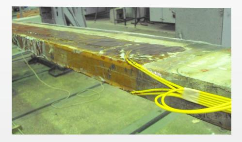
Система регистрации содержит источник света с широким спектром, спектрометр, измеряющий спектральные смещения ВБР, компьютер, пересчитывающий спектральные смещения в измеряемые деформации.
