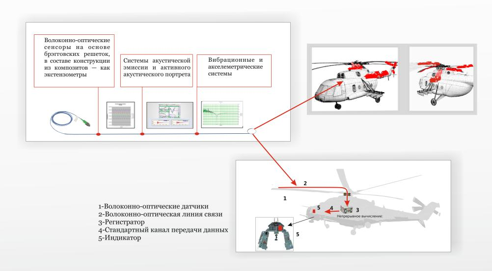
Датчики могут быть внедрены в композиционный материал или закреплены к поверхности контролируемой конструкции с помощью конструктивной оснастки.
