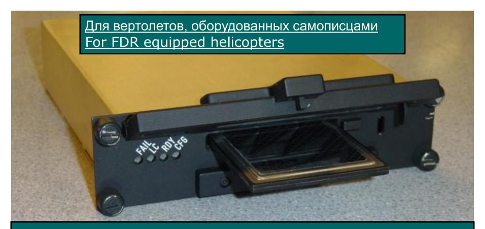
Твердотельные самописцы для экспресс-анализа Solid State Quick Access Recorder
