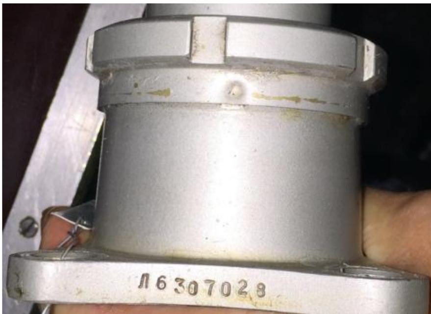
Ударная маркировка хвостового вала
