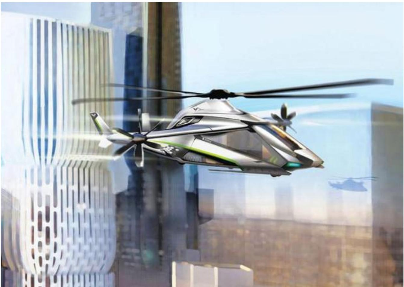
На новом вертолете планируется использовать французские турбовальные двигатели RTM322 мощностью 2270 лошадиных сил каждый (1693 киловатта). Крейсерская скорость полета машины составит 190 узлов (чуть больше 350 километров в час). Ее вертолет сможет поддерживать с одной работающей силовой установкой.
