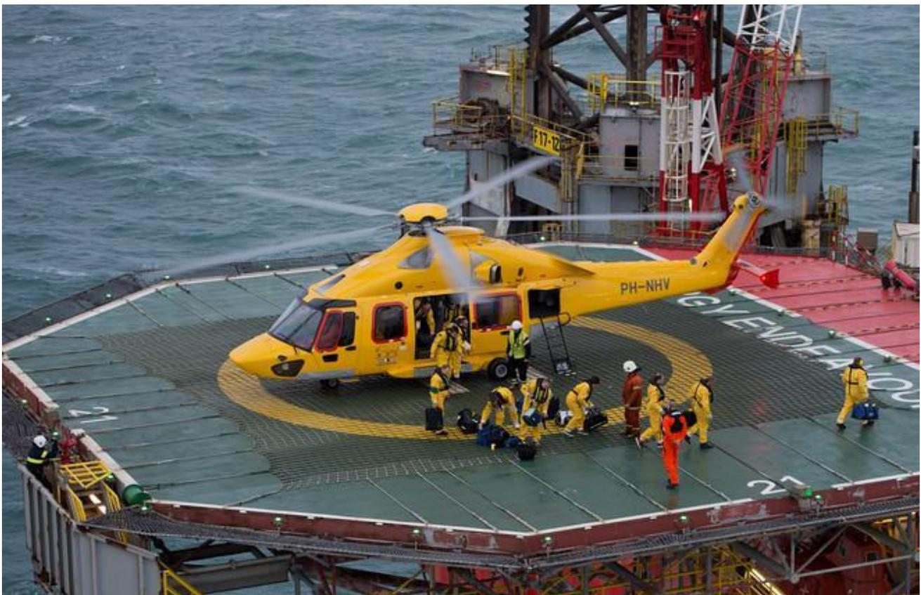
Для увеличения взлетного веса менять конструкцию воздушного судна не требуется. Эксплуатанты должны поменять только руководства по летной эксплуатации и обслуживанию. Несколько H175 с обновленными характеристиками уже используются для шельфовых работ в Северном море.
