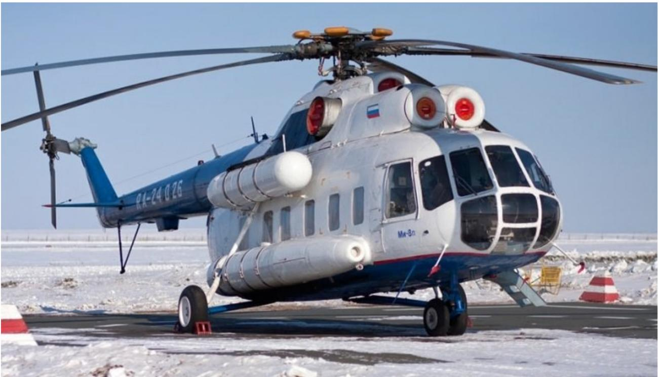
Основным отличием этой модификации Ми-8 от других является то, что на нем смонтирована специализированная система, позволяющая осуществлять оперативный запуск двигателей при температуре окружающего воздуха до  $-60^{\circ}\text{C}$ , причем в условиях как ангарного, так и безангарного базирования. Кроме того, грузовая кабина вертолета оборудована системой обогрева, специализированной теплоизоляцией, средствами для разогрева воды и пайков.
