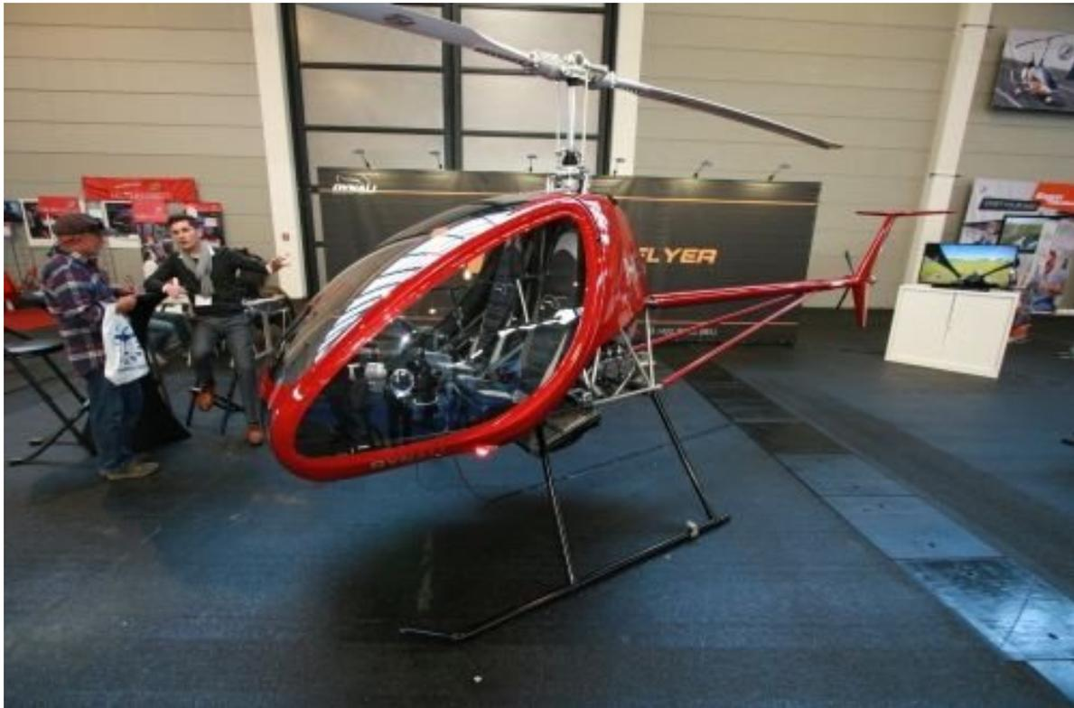
НЗ имеет просторную кабину, ширина которой составляет 1,3 м, что позволяет разместиться в ней двум достаточно крупным пилотам. Вертолет развивает крейсерскую скорость 140 км/ч (максимально допустимая - 155 км/ч) и имеет дальность полета 450 км. Практический потолок – 3000 м.
