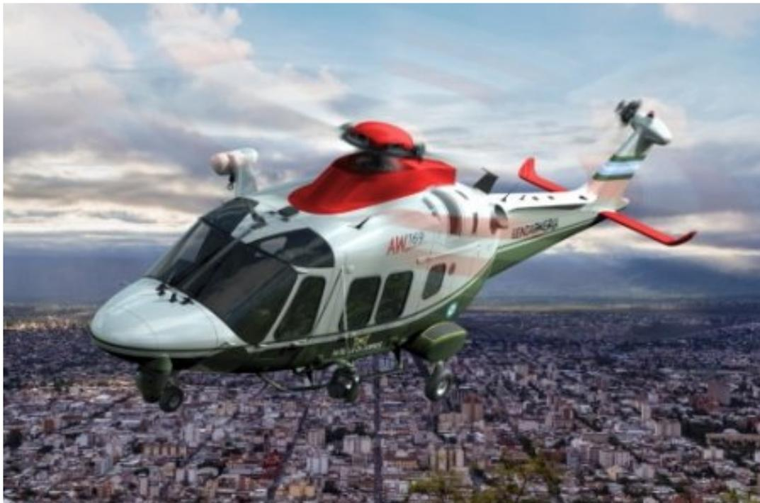
Новое приобретение для аргентинской жандармерии предполагается оснастить кабиной экипажа, приспособленной для полетов в шлеме расширенной визуализации, оборудованием для разрезания высоковольтных проводов. AW169 будет также иметь грузовой отсек, мегафоны, лебедки для десантирования и тепловизорами в передней части полусферы.
