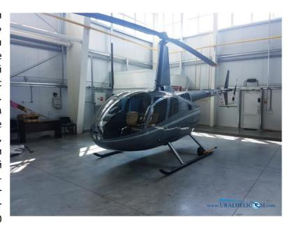
R66 Turbine сохраняет многие особенности конструкции R44, включая двухлопастную несущую систему, Т-образную ручку циклического шага и открытую конфигурацию кабины. Заметные отличия Robinson R66 — это увеличенная резервная мощность, улучшенные высотные характеристики, пятое сиденье и вместительное багажное отделение. Вертолет оснащен турбовальным двигателем Rolls-Royce RR300.
