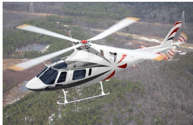
Вертолет получил салон в конфигурации Executive с кожаной отделкой кресел. Машина рассчитана на перевозку 6 пасс. Помимо стандартного оборудования она оснащена радиовысотометром, пылезащитным устройством (ПЗУ), системой питания переменного тока и двойным управлением. Кроме того, у ВС усилены лобовые стекла и увеличен до 2,3 м багажный отсек.
