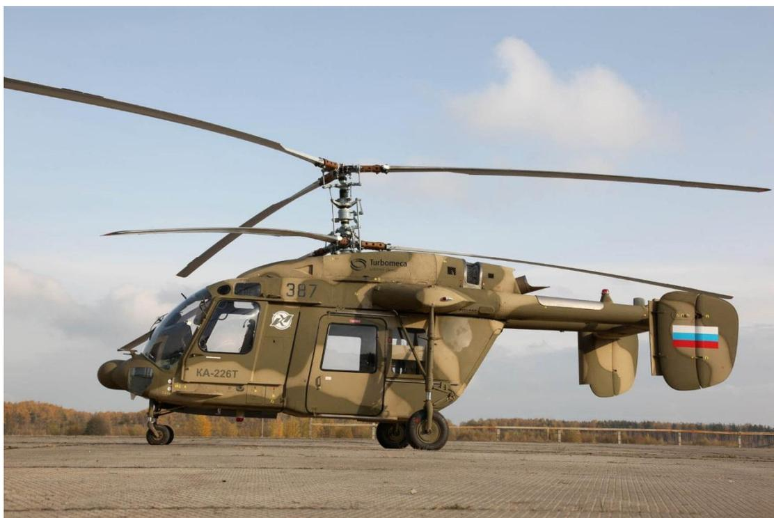
Легкий многоцелевой вертолет Ка-226Т с несущей системой, выполненной по двухвинтовой соосной схеме, обладает максимальной взлетной массой 3,6 тонны и способен перевозить до 1 тонны
