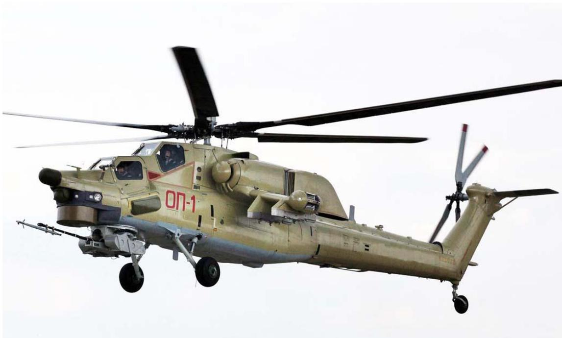
На вертолете установлена радиолокационная станция над втулкой несущего винта, что позволяет существенно расширить его возможности по круглосуточному обнаружению и поражению высокоточным оружием объектов в условиях плохой видимости.
