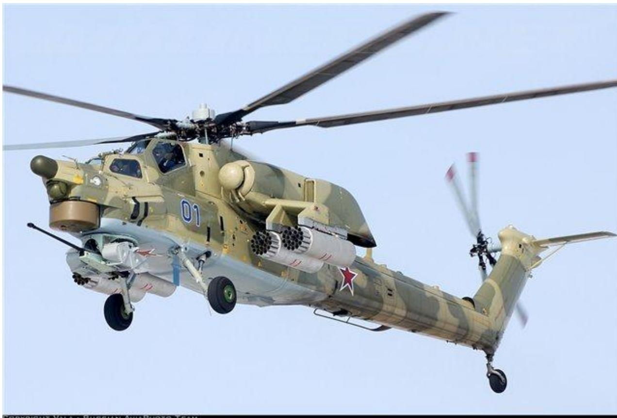
Огневая мощь – одно из наиболее ценных преимуществ Ми-28Н. Вооружение вертолета включает управляемое и неуправляемое ракетное вооружение, а также подвижную пушечную установку, которая оснащена пушкой калибра 30 мм. На балочных держателях предусмотрена подвеска противотанковых управляемых ракет "Атака" класса "воздух-земля" и "Игла" класса "воздух-воздух" с тепловой головкой самонаведения, а также блоков Б8В20-А и Б13Л1 с неуправляемыми авиационными ракетами типа С-8 и С-13.
