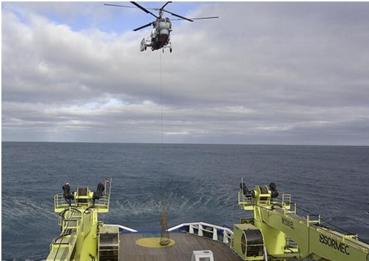
Экипажем вертолета Ка-27ПС были выполнены грузоподъемные операции с различными видами грузов весом до 3-х тонн. Сейчас продолжаются испытания с вертолетом Ка-29. Осуществляется доставка грузов грузовой сетью, а также длинномерных грузов, впереди предстоит погрузка контейнеров. Подобные испытания продлятся до конца сентября.
