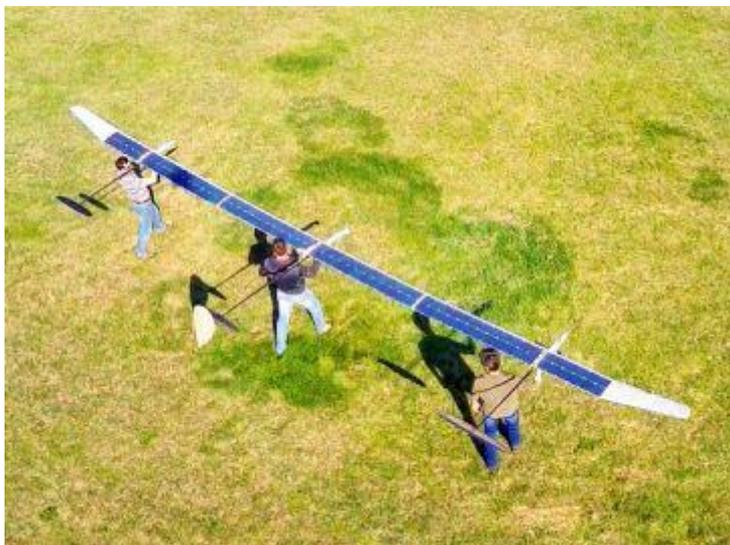
Беспилотный летательный аппарат (БЛА) «Сова» также называют атмосферным спутником. Высотный беспилотник предназначен для длительных полетов (продолжительностью несколько месяцев) на высотах 15-20 км. Цель создания БЛА типа «Сова» — это отработка новых технологий и подтверждение технического облика БЛА нового поколения, который с большой высоты сможет производить мониторинг пограничных территорий и морских районов, оперативно развертывать тактические системы связи над заданными районами и др.
