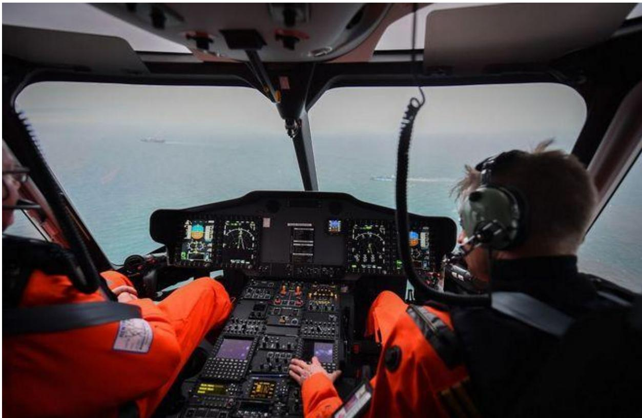
Изначально предполагалось, что система автоматической посадки на буровую установку станет доступна на H175 с конца 2016 г. Ранее она была одобрена для эксплуатации на среднем двухдвигательном вертолете H225. Кроме того, комплекс авионики Rig'N Fly получит и средний двухдвигательный вертолет H160, который еще предстоит сертифицировать.
