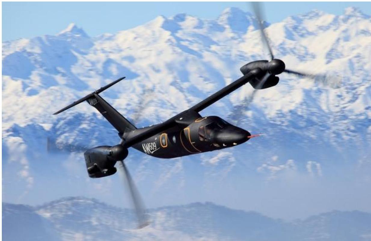
Двигатели AW609 располагаются на концах консолей крыла и способны поворачиваться вместе с винтами из вертикального в горизонтальное положение, обеспечивая соответствующий режим полета. В случае отказа одного из моторов машина может продолжить полет и совершить посадку.
