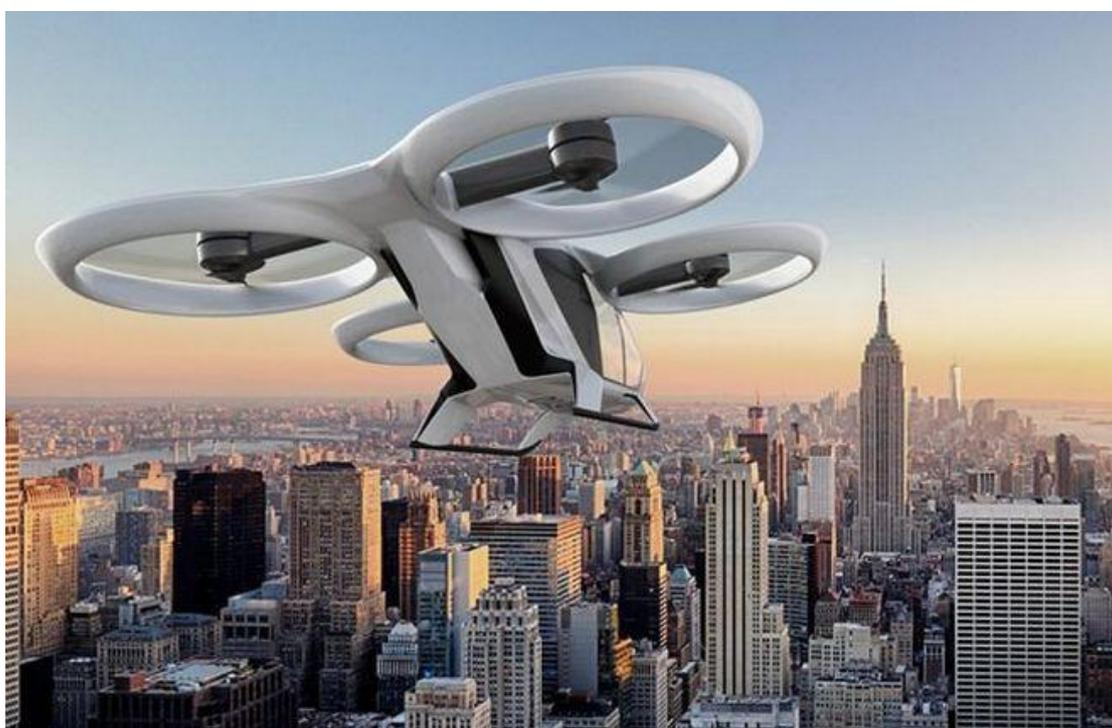
В рамках первого этапа тестов компания Airbus Helicopters проверила характеристики винтов в кольцевых обтекателях. Кроме того, была испытана совместная работа двух винтов, электромоторов и электросистем воздушного судна. CityAirbus будет оснащаться четырьмя винтами и восемью электродвигателями Siemens мощностью 100 кВт каждый. За питание будут отвечать восемь аккумуляторов мощностью 140 кВт.
