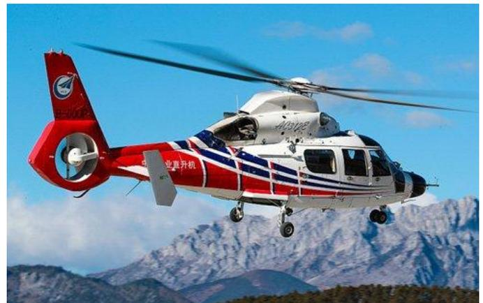
Во время испытаний AC312E поднялся на максимальную высоту 6300 м н.у.м. Кроме того, взлетев с аэродрома, расположенного на высоте 4500 м н.у.м., винтокрылая машина покрыла расстояние 500 км с грузом массой 500 кг, на высоте 5000 м н.у.м.. Как прокомментировал это достижение Ли Шенгвай, заместитель главного конструктора вертолета, это стало возможным благодаря двигателям Arriel 2H.
