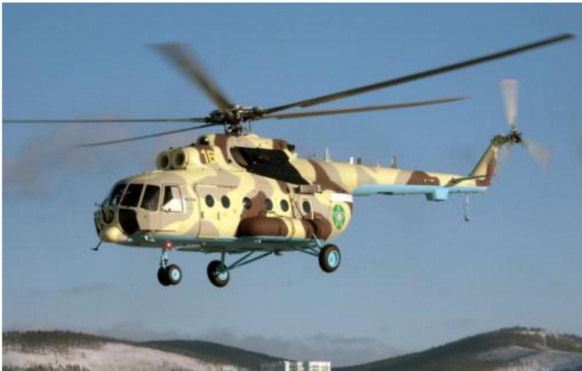
На вертолете Ми-171Е установлены новый несущий винт и Х-образный рулевой винт с лопастями из полимерных композиционных материалов, модернизированный автомат перекося, двигатель российского производства "Климов" ВК-2500ПС-03 с цифровой системой управления типа FADEC, а также модифицированный стабилизатор и килевая балка.
