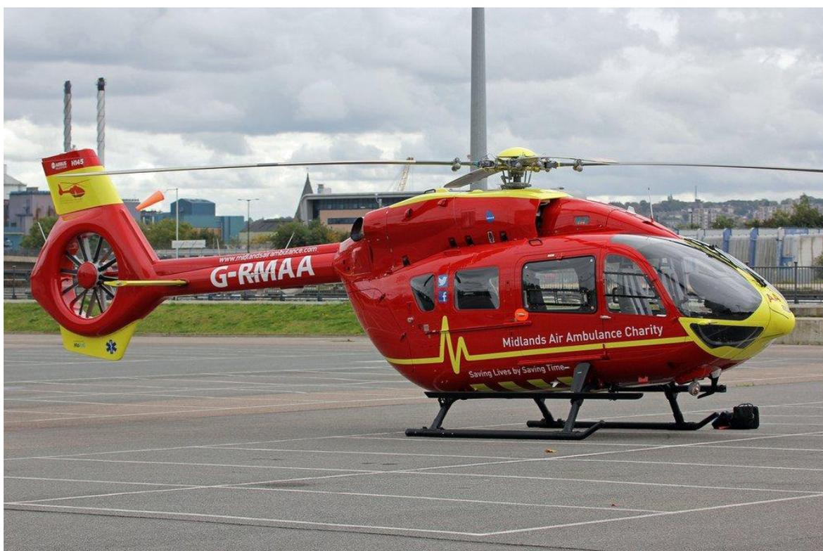
В марте 2017 года Европейское агентство авиационной безопасности сертифицировало H145 с улучшенными операционными характеристиками. Компания увеличила мощность вертолета в режиме висения при одном работающем двигателе в течение 2 минут. Апгрейд позволяет перевозить дополнительно 230 кг полезной нагрузки, что особенно важно при транспортировке людей на внешней подвеске.
