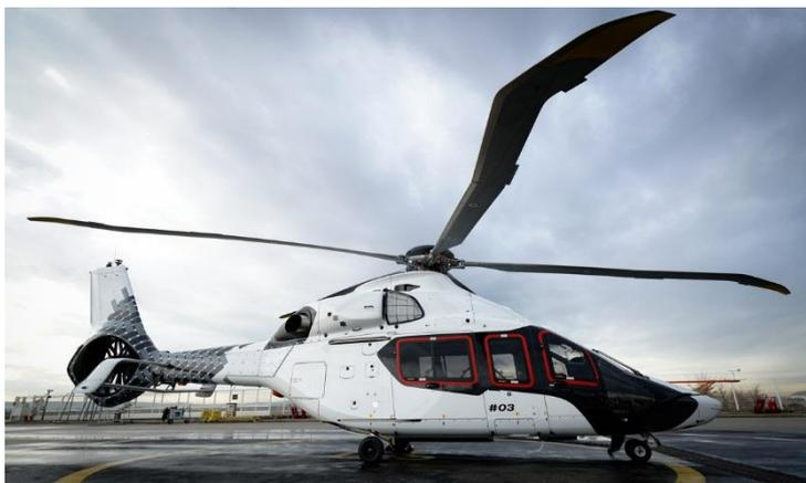
H160 – первый гражданский вертолет, оснащенный полностью композитным фюзеляжем, преимущества которого включают более легкий планер, который сберегает топливо, оптимизацию производительности и упрощенное техобслуживание.
