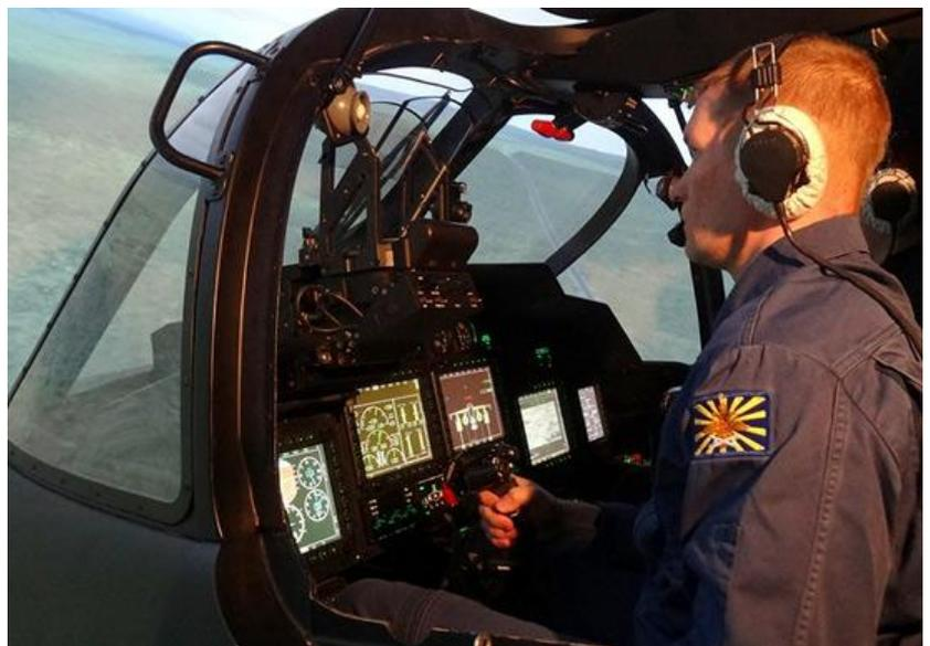
Новейшие компьютерные тренажеры выполнены в виде кабин вертолетов и оснащены симуляторами управления вооружением и техническими средствами авиационной техники. Они позволяют отрабатывать навыки управления вертолетом в различных погодных условиях, в дневное и ночное время суток, а также действия при возникновении нештатных ситуаций.
