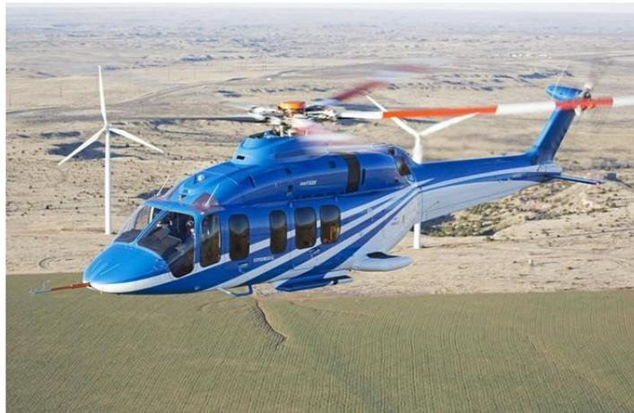
ВС совершало испытательный полет в условиях одного неработающего мотора (OEI — one engine inoperative) при возрастающей скорости. Проверка в числе прочего выявила недостаточность автоматической системы безопасности в обучающем программном обеспечении.
