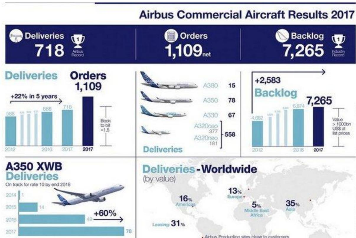
Компания Airbus в прошлом году поставила 558 узкофюзеляжных самолетов семейства A320: 181 борт A320neo и 377 самолетов A320ceo (+2%). Четыре линии финальной сборки этих ВС дадут возможность компании увеличить темпы сборки данной модели до 60 ед. в месяц к середине 2019 г., напомнил авиастроитель.
