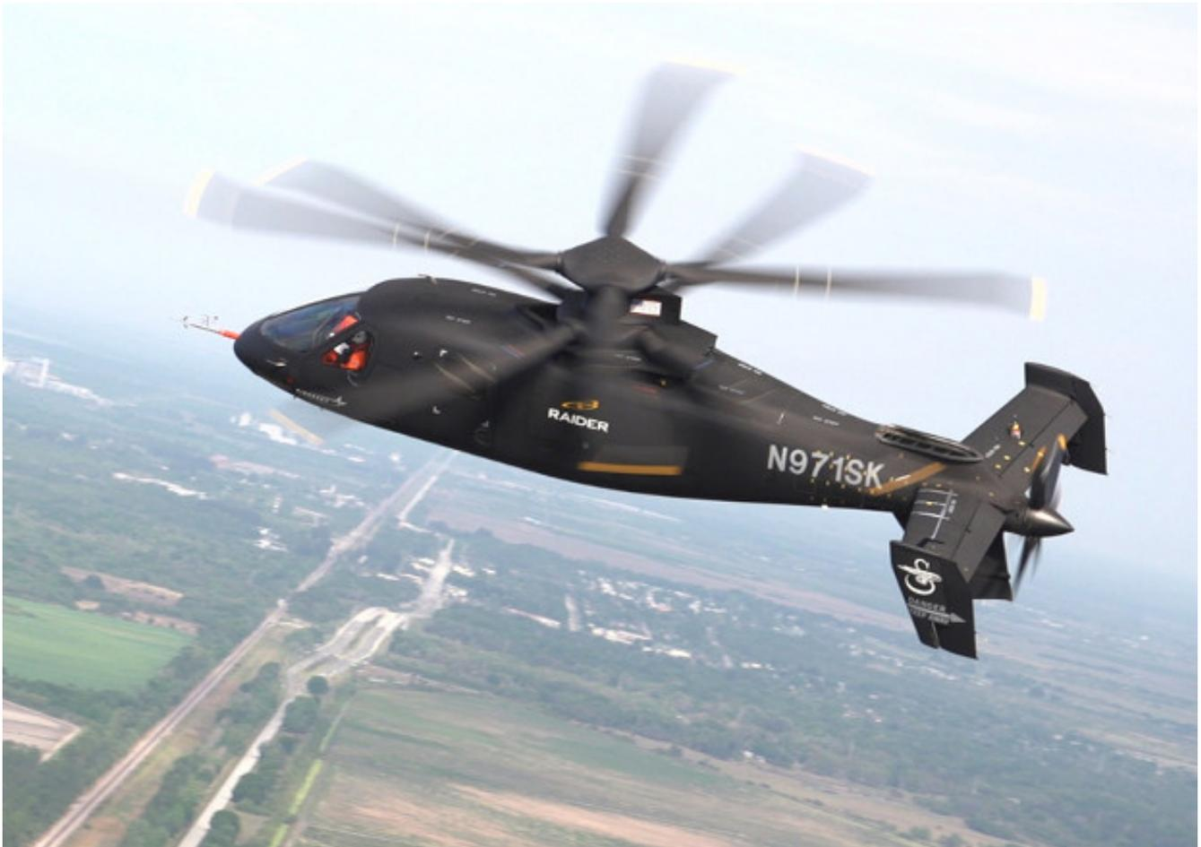
Ранее S-97 прошел испытания низкоскоростными пролетами, выполнил несколько полетов на скорости 150 узлов (278 километров в час). Благодаря допуску к полномасштабным испытаниям скорость полета разведывательного вертолета планируется довести до 200 узлов и перешагнуть этот рубеж до конца текущего лета. В компании Sikorsky утверждают, что в конструкции второго прототипа S-97 были исправлены недочеты, которые и послужили причиной жесткой посадки в прошлом году.
