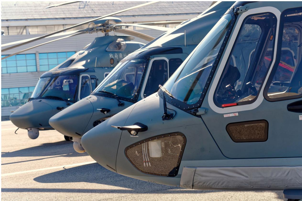
7-тонный H175, ранее известный как EC175, был разработан компанией Airbus Helicopters в качестве вертолета среднего класса нового поколения, сертифицированного в соответствии с самыми строгими требованиями отрасли. В ходе работы над моделью был повышен уровень безопасности и комфорта пассажиров, расширен спектр применения, упрощена процедура технического обслуживания и увеличена экономичность машины для соответствия ожиданиям клиентов, сообщается в релизе производителя.
