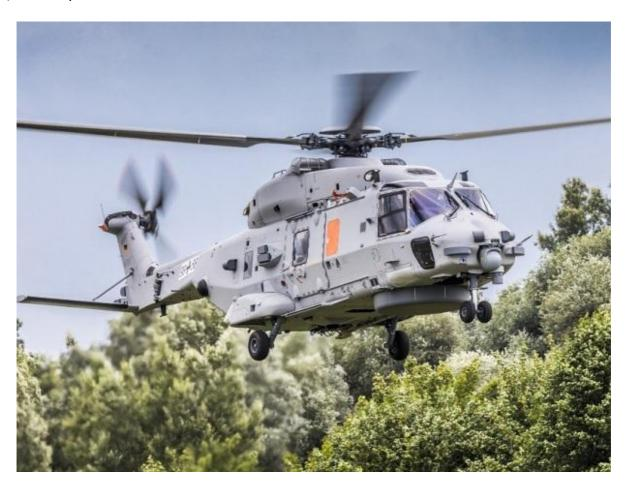
В 2015 году ВМС Германии заказали разработку модифицированной версии вертолета NH90 NFH (NATO Frigate Helicopter), получившей название Sea Lion. От базовой версии "Морской лев" отличается специальным навигационным оборудованием, новой системой опознавания "свой-чужой" и двумя штатными 12,7-мм пулеметами.
