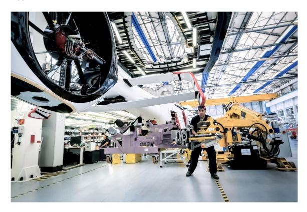
Н160 оснащен полностью композитной конструкцией с динамичными линиями и футуристическим дизайном, отличающимся от предшественников. Он имеет плоский пол кабины, огромные иллюминаторы и большое багажное отделение грузоподъемностью 661 фунт. Пассажирскую кабину можно сконфигурировать для размещения четырех или восьми пассажиров со всеми «прибамбасами», которые присутствуют в новейших моделях крупных бизнес-джетов, или же просто разместить 12 человек.
