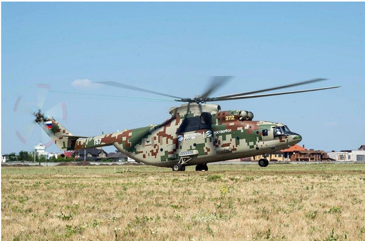
Дальность полета Ми-26Т2В с грузом массой 20 т в кабине составляет 590 км, а перегоночная – 1920 км. Максимальная скорость полета может достигать 295 км/ч, а динамический потолок – 4,6 тыс. м.
