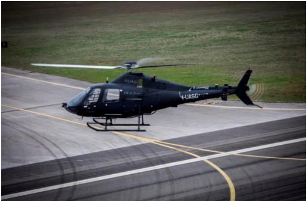
Последняя вертолетная беспилотная воздушная система (RUAS) является результатом работы инженеров PZL-Świdnik и Leonardo Helicopters. Конструкция машины базируется на легком вертолете SW-4, военная версия которого используется в польской армии уже много лет.
