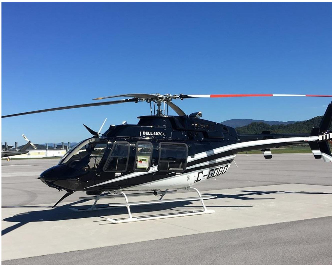
Bell 407GX<sub>i</sub> оснащается новым газотурбинным двигателем Rolls-Royce M250-C47E/4 с двухканальной системой FADEC, который обеспечивает исключительную производительность при высоких температурах воздуха и на большой высоте, улучшенную топливную экономичность и возможность крейсерского полета со скоростью 133 узлов/246 км/ч.
