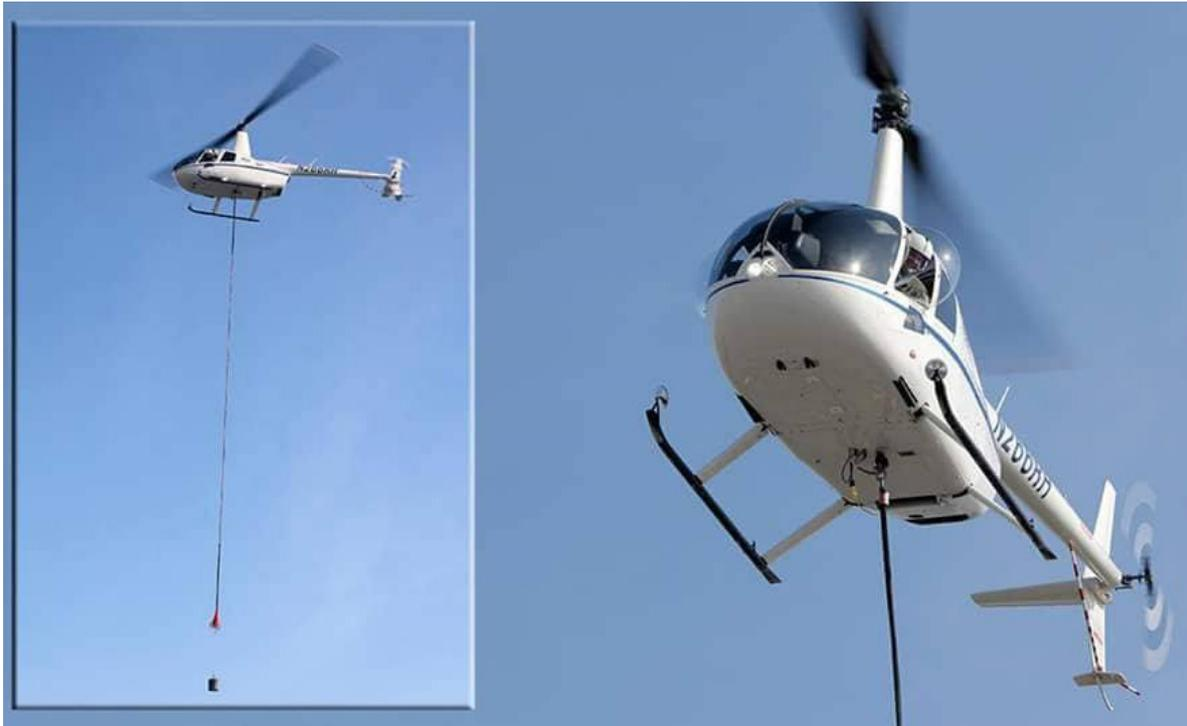
Система предусматривает возможность дистанционного управления внешним оборудованием, например, экстендером крюка или корзиной для сброса воды.
