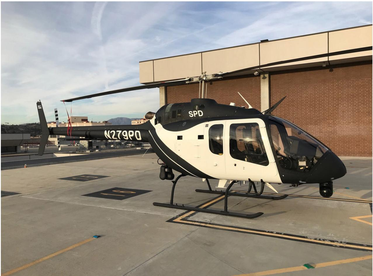
Bell 505 Jet Ranger X – легкий пятиместный вертолет с двигателем Turbomeca Arrius 2R, системой FADEC, крейсерской скоростью 232 км/ч, дальностью 667 км, полезной нагрузкой 680 кг. К услугам клиентов вертолет предлагает полностью интегрированную «стеклянную кабину» для уменьшения нагрузки пилота, отличный обзор для экипажа и авионика G1000H. Дополнительной функцией
