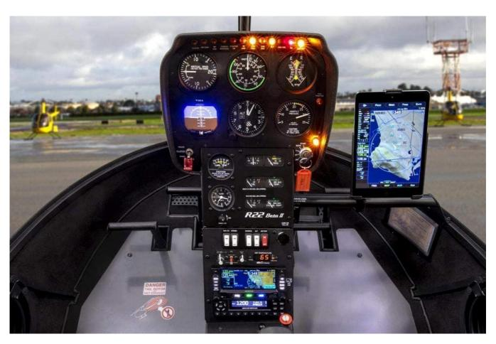
Навигаторами Avidyne IFD 400 можно управлять как с сенсорного экрана, так и кнопками — это позволяет устанавливать их как на нижней центральной приборной консоли вертолета, так и на боковой консоли пилота. Стандартная конфигурация навигаторов серии IFD 400 включает режим ночного видения, а также Wi-Fi-модуль, используемый для установки беспроводной связи с iPad.
