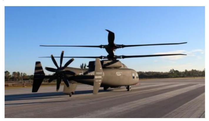
Разработка SB>1 ведется с 2015 года. В ней использованы наработки, полученные во время разработки и испытаний демонстраторов скоростных вертолетов X-2 и S-97 Raider. Масса вертолета составляет 13,6 тонны. Он сможет развивать скорость до 250 узлов (463 километра в час) и перевозить 12 человек десанта. Машина построена по соосной схеме с хвостовым толкающим винтом.
