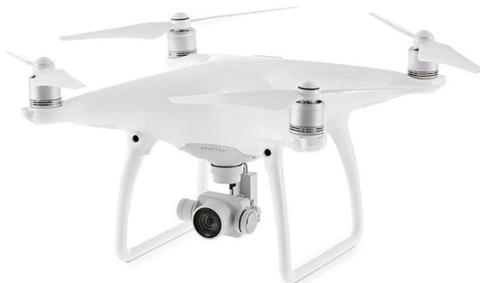
Также Phantom 4 может в автоматическом режиме следовать за владельцем или выбранным объектом. Подобная функция была доступна и в предыдущих моделях Phantom, однако новый беспилотник ориентируется не по GPS, а при помощи камеры. Чтобы выбрать объект слежки для дрона, владельцу достаточно выделить его на экране своего смартфона или планшета. При этом включение режима слежки не отражается на способности штатной камеры снимать фотографии и записывать видео.
