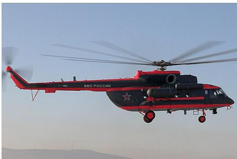
Арктический вертолет способен летать в условиях полярной ночи без визуальной и радиоориентировки при температурах от +40 до -55 градусов на расстоянии до 1500 км в тундре, в открытом море и над арктическими льдами. Для экипажа и пассажиров предусмотрены все удобства. Также имеется оборудование для поисково-спасательных работ на воде и во льдах и транспортировки больных.
