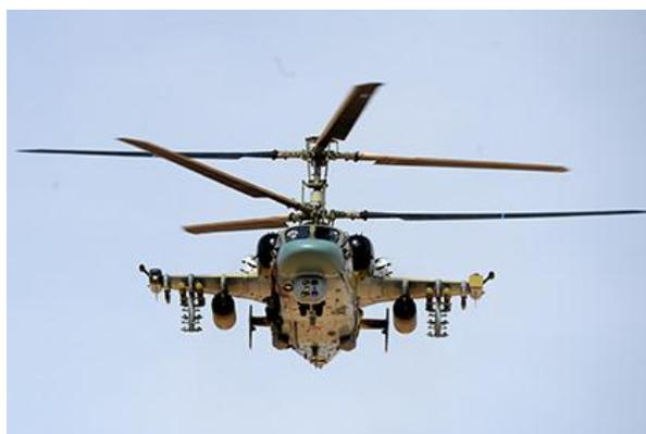
Ударный вертолет Ка-52 «Аллигатор» запущен в серийное производство в 2008 году. Машина стала развитием ударного вертолета Ка-50 «Черная акула», основным отличием является экипаж из двух человек и полностью новый комплекс бортового радиоэлектронного оборудования. Сейчас Арсеньевская авиационная компания «Прогресс» выполняет контракт с Минобороны на строительство 146 таких вертолетов (более половины уже переданы в войска).
