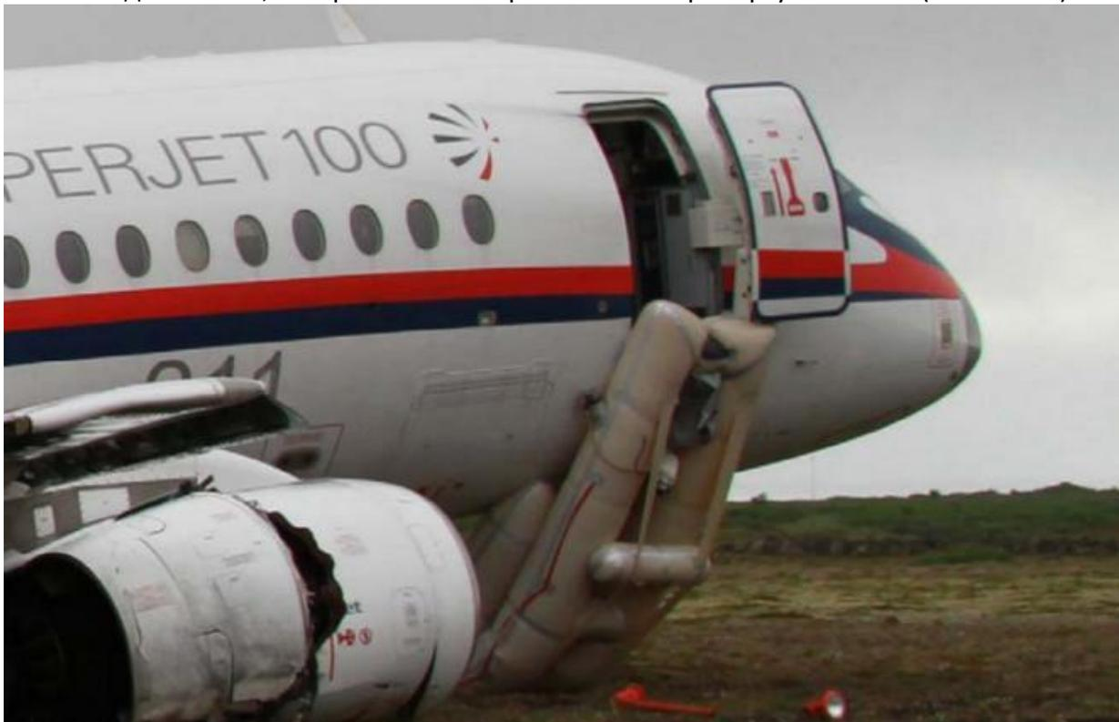
Как говорится в документе, после того как самолет приземлился без шасси, один из надувных трапов, расположенный спереди и справа, из-за сильного ветра завернулся под носовую часть фюзеляжа. В Комиссии по обеспечению безопасности на транспорте Исландии (ITSB) напомнили, что согласно стандартам EASA аварийные трапы должны выдерживать ветер силой 25 узлов (12,86 м/с), дующий под любым углом. На момент аварийной посадки SSJ 100 скорость ветра не превышала 21 узла (10,8 м/с).
