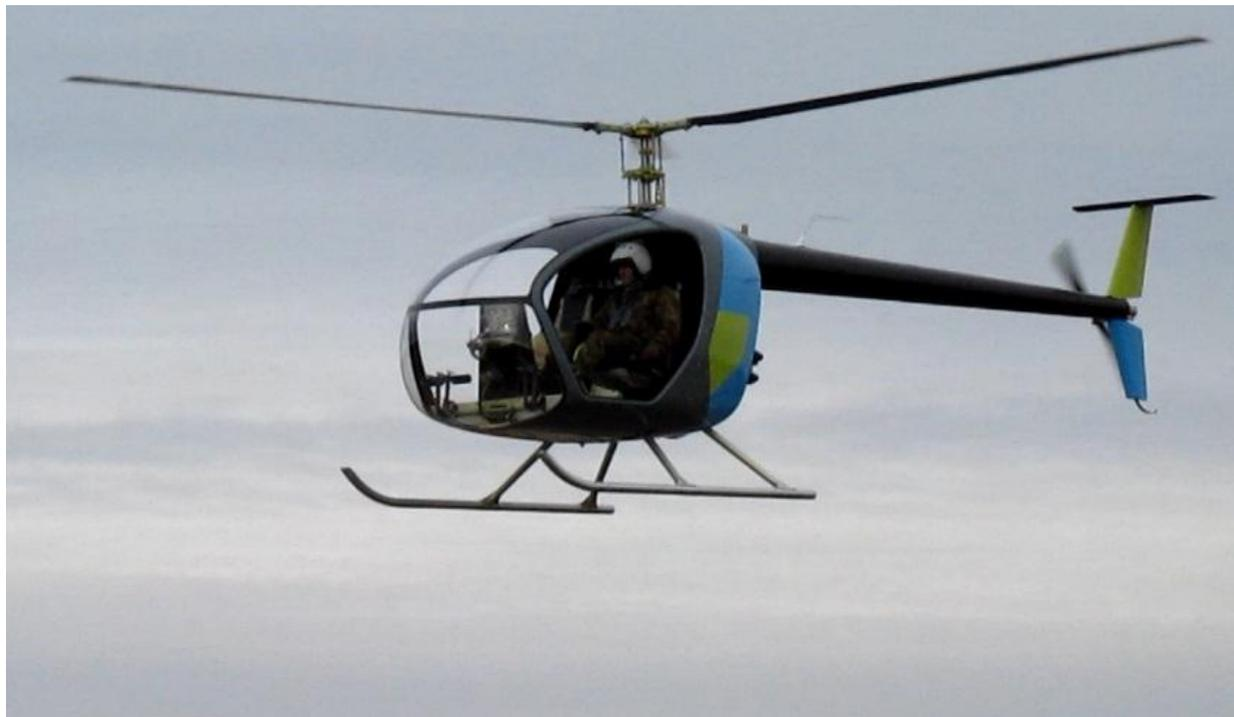
Двигатель вертолета работает на стандартном автомобильном топливе — бензине АИ-95 и способен разгонять летательный аппарат до 209 км/ч, что является рекордной скоростью для данного класса вертолетов. При этом, запаса топлива хватает на 3 с лишним часа полета, за которые SL-231 "SCOUT" успевае т преодолеть 600 км. Компоновка машины напоминает двухместную, однако вертолет способен нести трех человек с багажом.
