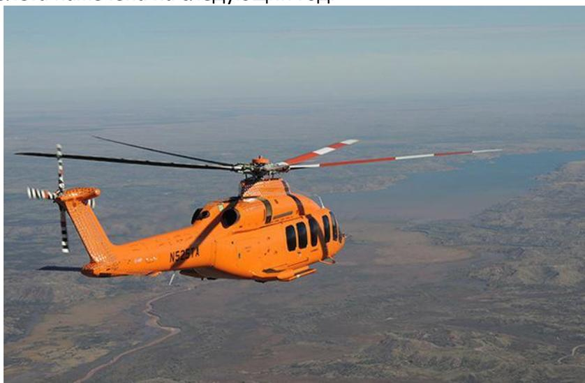
8-тонный Bell-525 оснащается двумя турбовальными двигателями GE CT7-2F1 мощностью 1800 л. с. каждый. Производитель позиционирует его как первый коммерческий вертолет с электродистанционной системой управления (ЭДСУ). Ожидается, что ВС сможет брать на борт 16–20 пасс. (не считая двух пилотов). Расчетная дальность полета — 926 км.
