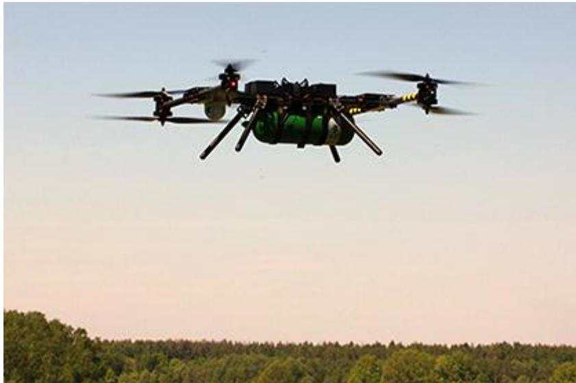
Масса беспилотника составляет 12 килограмма, его энергетическая установка имеет мощность 1,3 киловатта, полезная нагрузка — 0,5 килограмма. Коптер использует водородно-воздушные топливные элементы. Последние разработаны в Институте проблем химической физики РАН при участии специалистов из Центрального института авиационного моторостроения имени Петра Баранова и Объединенной авиастроительной корпорации.
