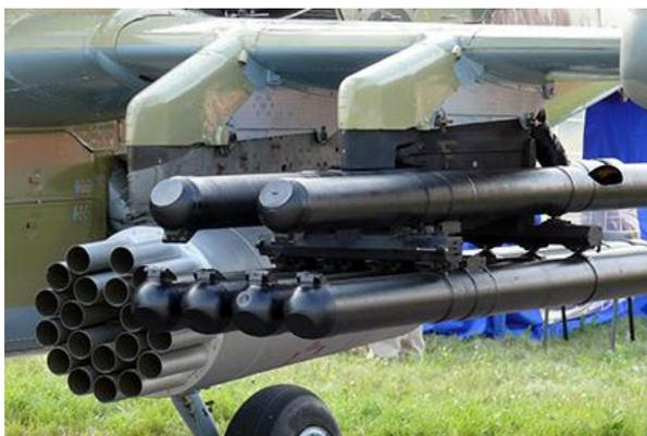
Противотанковый комплекс управляемого вооружения 9К121М «Вихрь-М», использующий ракету с автоматическим лазерным наведением 9А4172К «Вихрь-1», разработан в тульском КБП. Ракеты способны поражать бронированные объекты на дистанции до 10 километров. Комплекс находился в разработке с 1990 года для оснащения штурмовиков Су-25ТМ и вертолетов Ка-50. В данный момент комплексом будут оснащаться вертолеты Ка-52.
