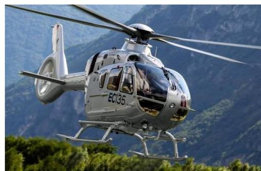
В отличие от предыдущей версии H135 оснащается удлиненными лопастями несущего винта и более мощными двигателями, для оптимальной работы которого установлено обновленное программное обеспечение FADEC. Благодаря этому вертолет обладает улучшенными характеристиками при работе в условиях высокогорья и более жаркого климата, а также лучше приспособлен для выполнения заданий в условиях открытого моря. В Airbus
