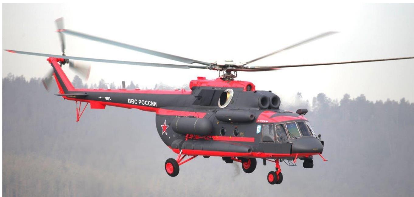
Безопасность полетов существенно повышена за счет установки на вертолетах цифрового автопилота, морских спасательных костюмов пилотов, спасательных плотов, системы наблюдения за воздушной обстановкой, предупреждающей экипаж о сближении с другими воздушными судами. Ми-8АМТШ-ВА также оснащен дополнительной теплоизоляцией, оборудованием для разогрева пищи для членов экипажа и личного состава.
