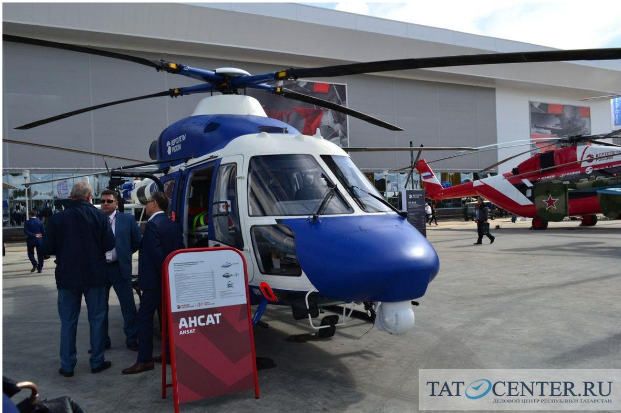
Полицейская версия вертолета «Ансат» оснащена платформами для транспортировки группы специального назначения от 4 до 6 человек, а также фермой для десантирования с применением устройств скоростного спуска, которая может быть сброшена в случае экстренной необходимости. Данное оборудование легкоъемное и позволяет в случае необходимости быстро изменить функционал вертолета из полицейского в медицинский.
